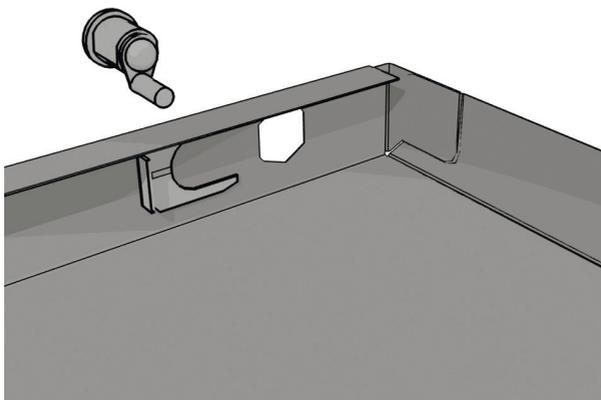
Вставить нижний отгиб в передней части крыши в соответствующие пазы в передней части боковых стенок. Проследить за тем, чтобы верхняя пластина запорной планки оказалась над роликом замка. Задвинуть крышу назад до упора и опустить ее заднюю часть. Прикрепить крышу к задней стенке с помощью саморезов.
