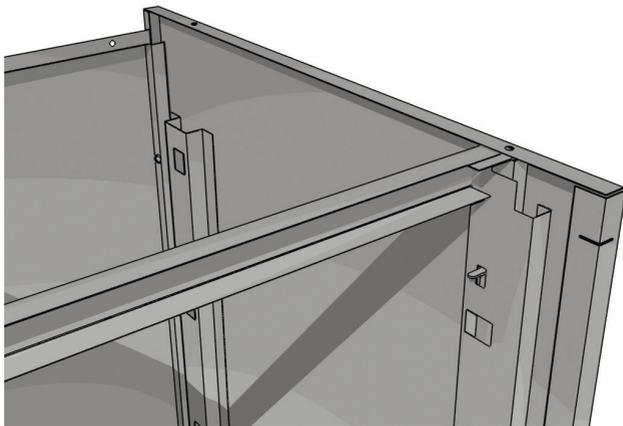
Вставить дно в нижнюю часть конструкции. Опустить его вниз до упора.
