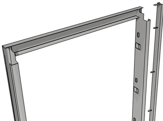
Установить раму (с запорной планкой), задвинув ее до упора в полости передней части боковых стенок.
