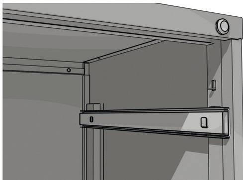
Выдвинуть до упора внутренние элементы направляющих и повесить на них ящик, используя соответствующие зацепы. При необходимости в каждое отделение ящика можно вставить разделитель (входит в комплект поставки).
