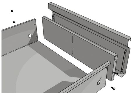
Вставить в соответствующие пазы передней части ящика перегородку, присоединить к корпусу заднюю торцевую стенку и закрепить ее с помощью саморезов.
