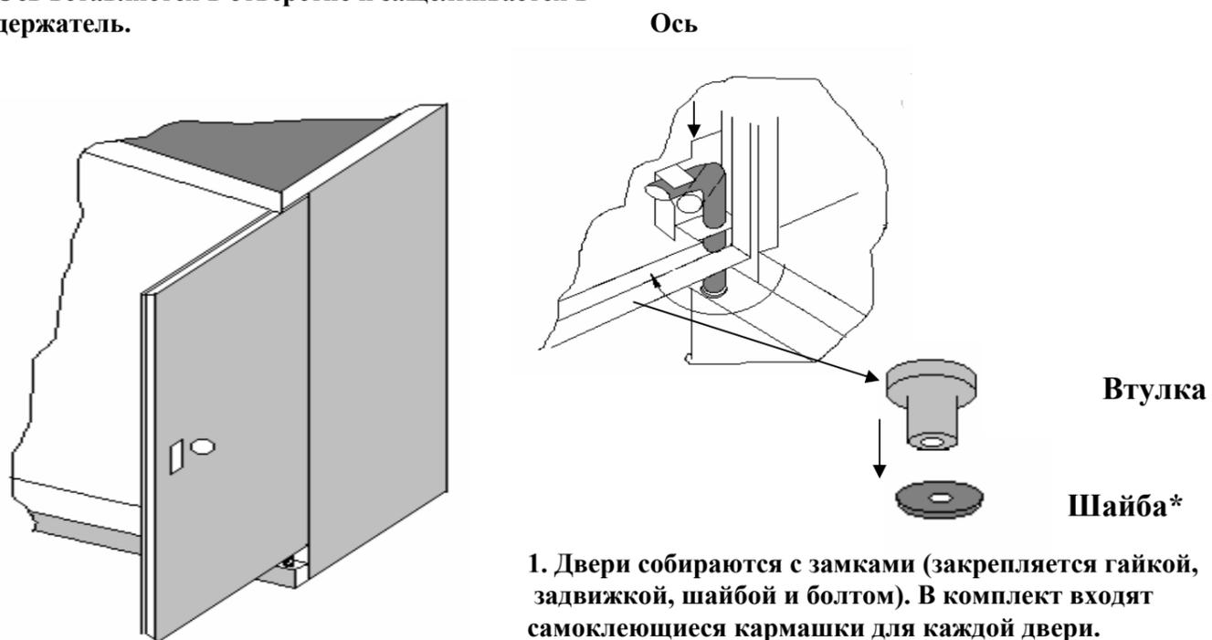
\*Шайба предназначена для выравнивания зазоров между дверью и корпусом и ставится заказчиком по собственному усмотрению.
