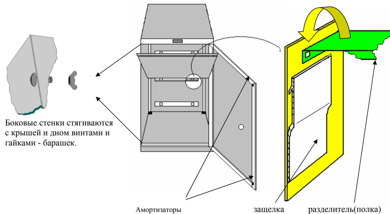
Полка вставляется через пазы боковых стенок (параллельно полу и крыше) и пазами закрепляется в конструктивные выступы на задней стенке.
