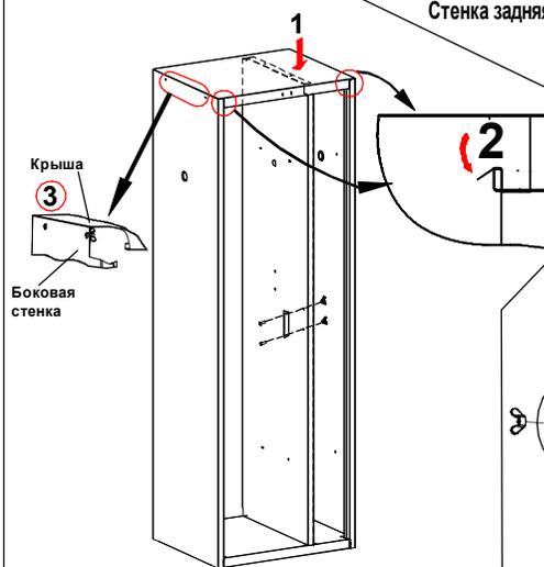
1. Установить локер вертикально. Установить крышу, и отогнуть язычки.
