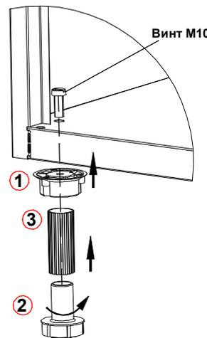
1. Установить локер горизонтально на заднюю стенку. Установить регулируемые опоры.
