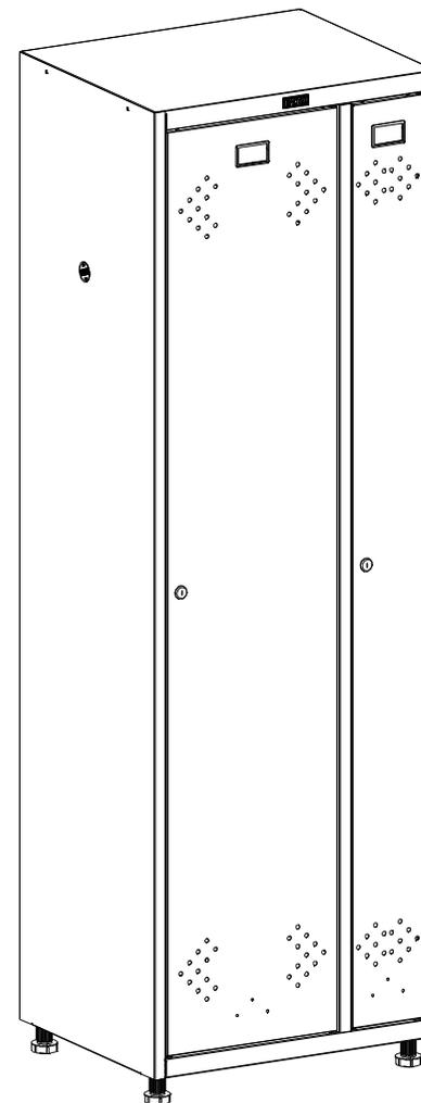
Конструкция шкафа предусматривает сборку или на саморезах, или на заклепках. В случае сбора на заклепках, они устанавливаются вместо саморезов в местах, указанных на рисунках.
