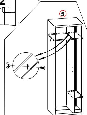
1. Верхние полки установить в зацепы и закрепить 2-мя винтами и 2-мя гайками-барашками.
